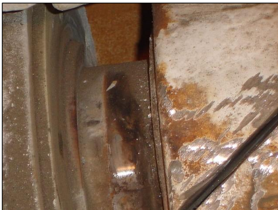
Découpage charnières porte AR – Punching of transom door's hinges
